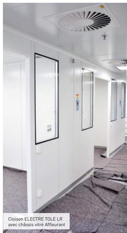
Cloison ELECTRE TOLE LR avec châssis vitré Affleurant
