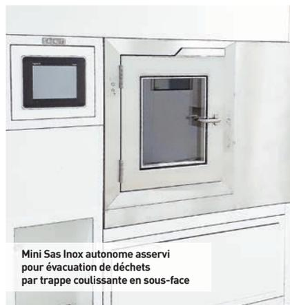
Mini Sas Inox autonome asservi pour évacuation de déchets par trappe coulissante en sous-face
